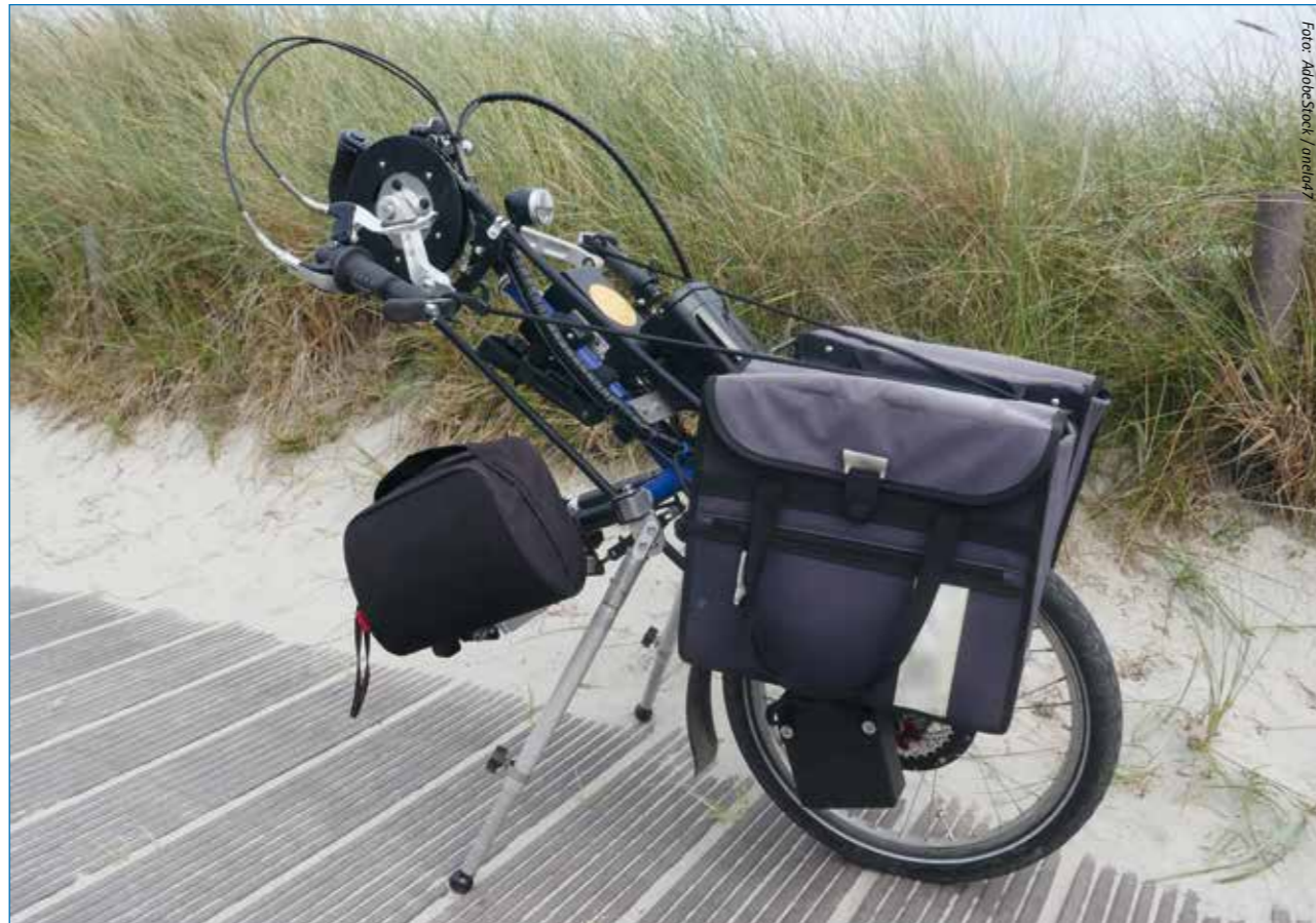
Handbike mit einer elektrischen Rollstuhlzughilfe mit Handkurbelunterstützung
