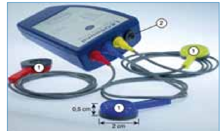
Abb. 2 Der LEOSound-Recorder mit drei bioakustischen Sensoren (1) und Umgebungs-mikrofon (2). Die weiche und flache Ausführung der Sensoren ermöglicht bequemes und komfortables Liegen auch in Rückenlage.
